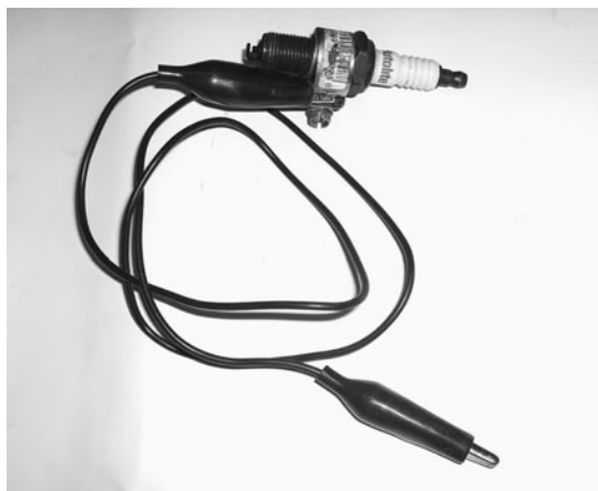
Fig. 10-10. Ignition testing spark plug.
