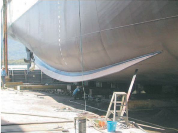
Fig. 2.52 Bilge keel on a tug boat
