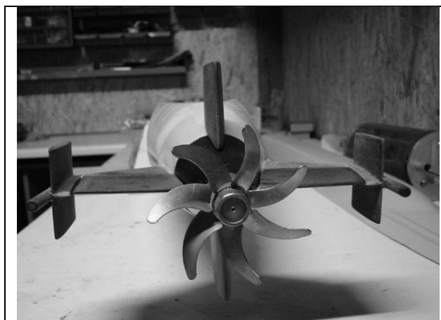
شکل ۴-۱۳: پروانه زیردریایی و سطوح کنترلی
