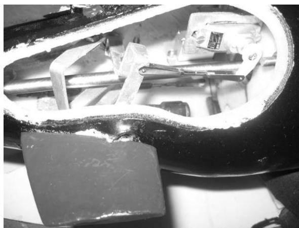
شکل ۸-۱۴: لینک‌های اتصال و انتقال حرکت سرو موتور به سطوح کنترلی
