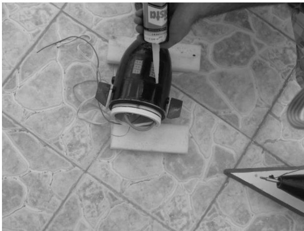
شکل ۸-۵۰: بستن و آببندی دریچه مربعی سینه شناور
