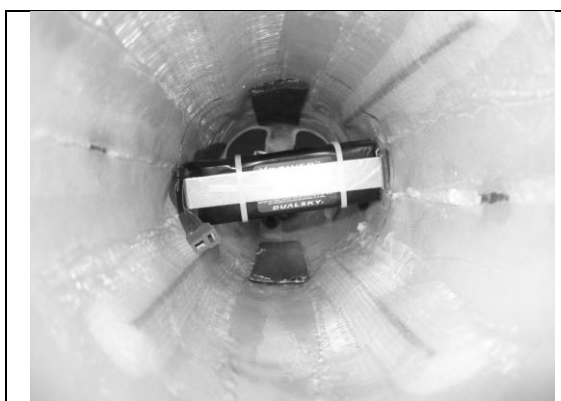
شکل ۸-۴۳: نحوه قرارگیری باتری سیستم‌های داخلی
