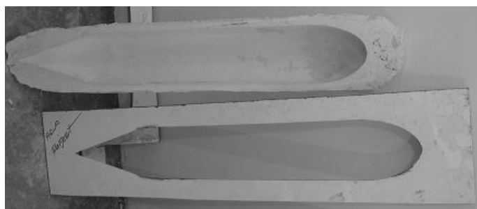
شکل ۸-۲: قالب گچی نیم بدنه
