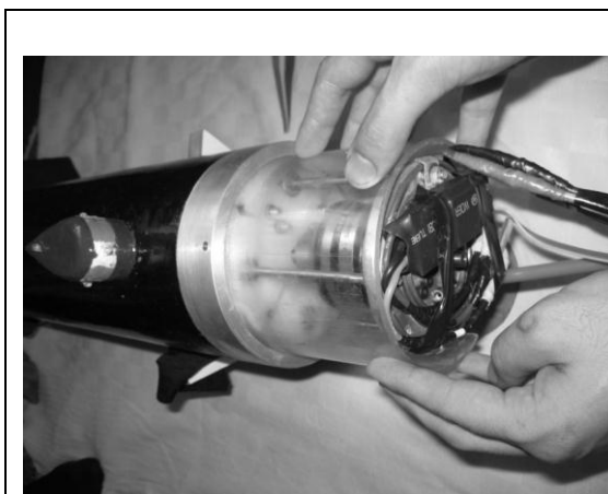
شکل ۸-۲۳: چگونگی جانمایی مجموعه موتور در بدنه
