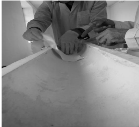
شکل ۳-۸: لایه گذاری کامپوزیتی در داخل قالب گچی
