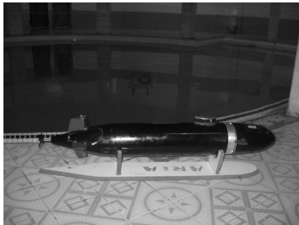
شکل ۸-۱۳: قرار گرفتن سطوح کنترلی روی بدنه
