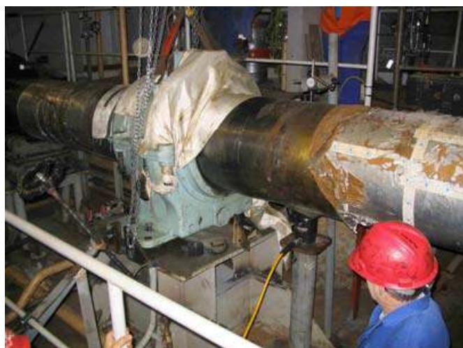
شکل ۲۲-۲: تست up jack بر خط شفت یاتاقان ها
