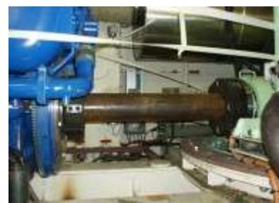
شکل ۱-۲: Tooth Coupling and Flexible Coupling Shafting
