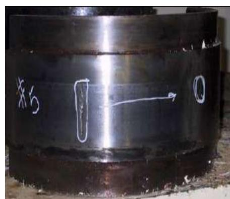
شکل ۱۳-۱: خرابی واردہ بر یک یاتاقان غلتکی
