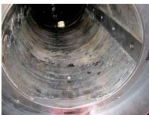
شکل ۱۴-۱: از دست دادن خاصیت روغن کاری هیدرودینامیکی ناشی از ازدیاد آب در روغن
