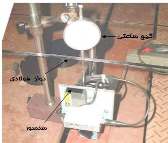
شکل ۲-۳۸: تنظیم سنسور با استفاده از گیج ساعتی
