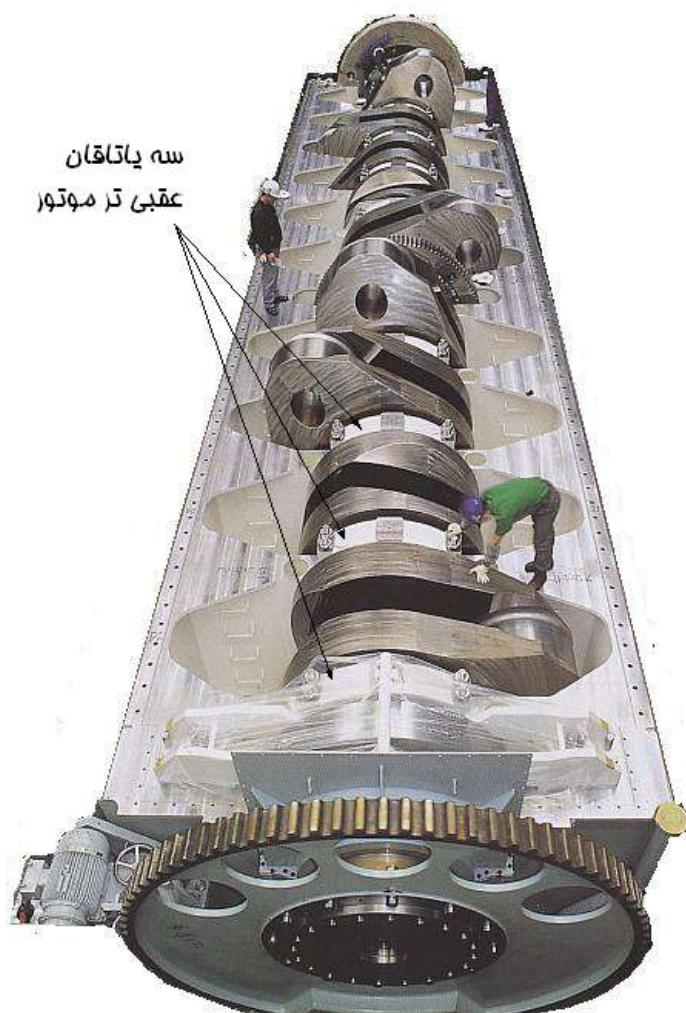
شکل-۲: قرار گیری میل لنگ در قاب موتور
