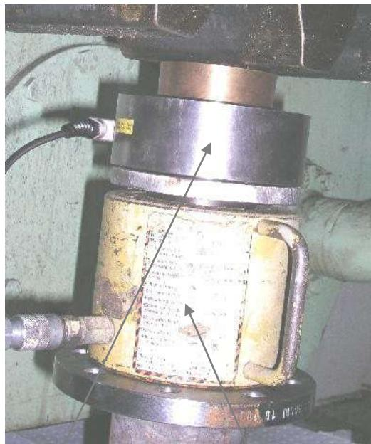
شکل ۳۴-۳: جک هیدرولیک به همراه سلول اندازه گیری نیرو
